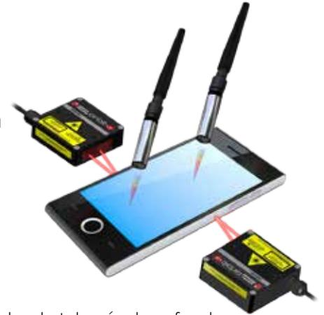
Verificar vidro de telemóvel confocal juntamente com lasers que usam Orbit®
