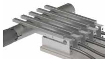
Com as mesmas vantagens que a deflexão paralela, a deflexão de folha única oferece o acesso de construção de medição para ainda mais pontos de medição. Com uma utilização cuidadosa dos braços extensíveis, as medições podem ser efetuadas dentro de ranhuras ou entre funcionalidades, onde um sensor convencional tipo caneta não consegue chegar.
