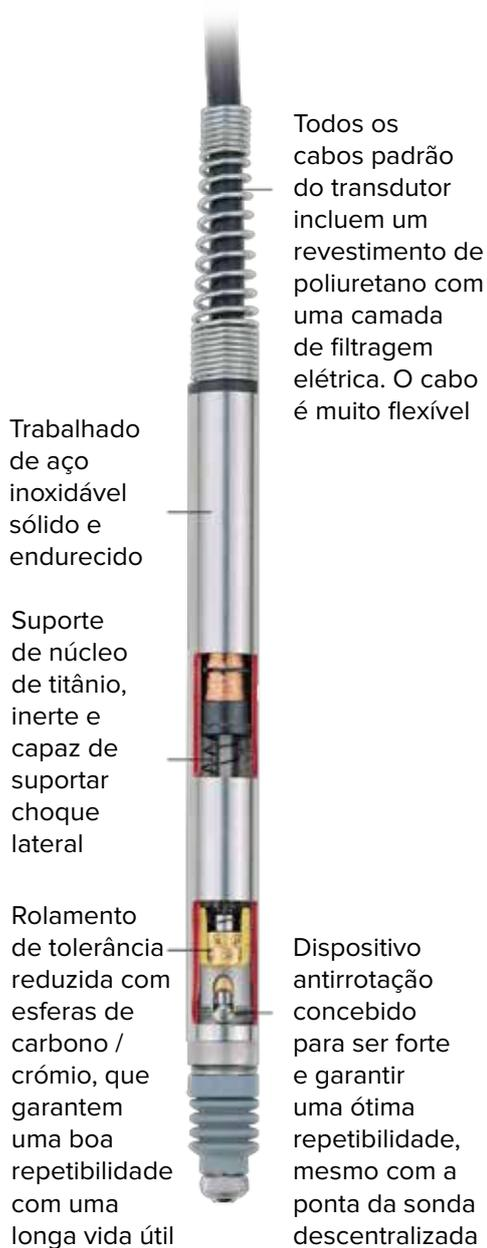
**As sondas de medição de contato oferecem, muitas vezes, a única solução econômica para uma vasta gama de aplicações de medição e posicionamento em diversas indústrias.**
