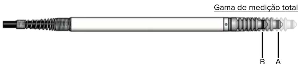
A saída pode ser escalonada ao longo de uma gama limitada para aumentar sensibilidade e resolução. Por exemplo, uma gama entre 1 mm e 1,5 mm pode ser escalonada de 0V a 10V.
